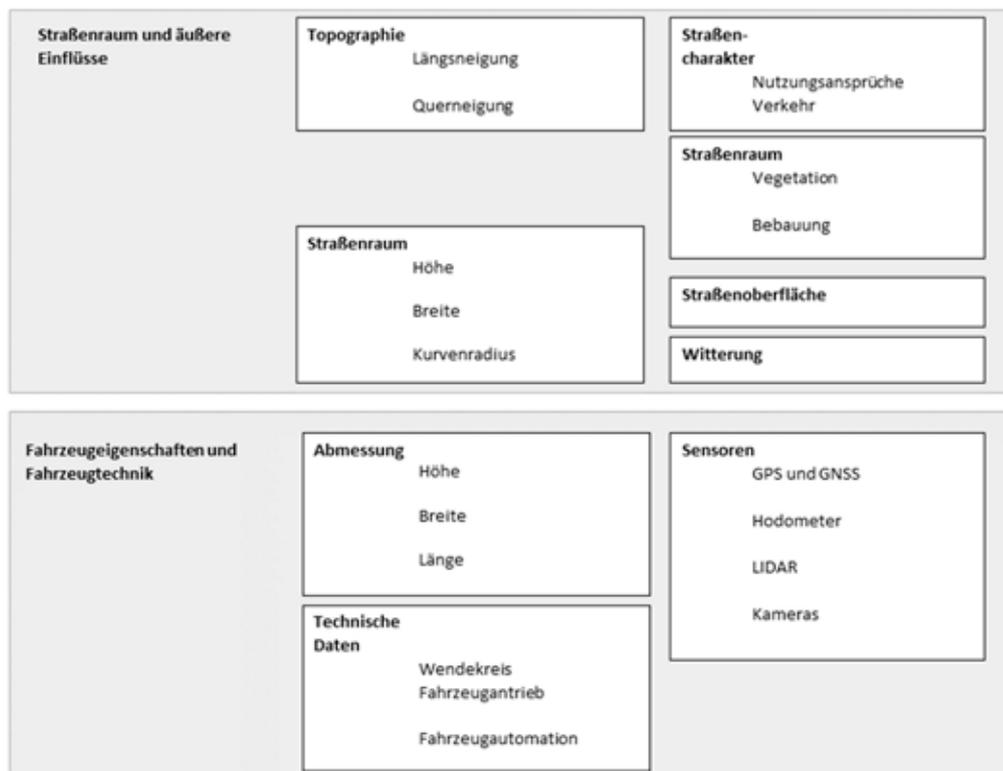
Abbildung 4: Einflussfaktoren auf den Betrieb autonomer Shuttlebusse<sup>4</sup>
