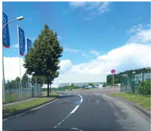
Abbildung 3: Im Projekt TERMINAL zusätzlich angebrachte Straßenmarkierung zur Lokalisierung des Fahrzeugs
